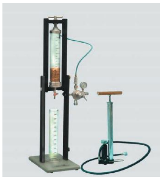
140-62 Фильтр-пресс с песчаной прослойкой
