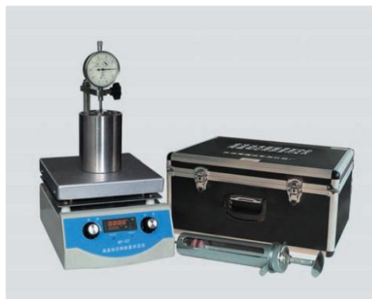
150-82 Динамический тестер набухания ЛРНТ
