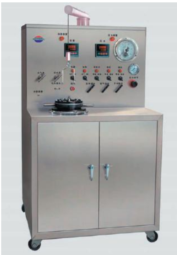
1910 Камера набора прочности
